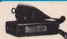
TM732 - Nuovo bibanda 50W VHF e 35W UHF, programmabile, 50 memorie, pannello frontale staccabile
