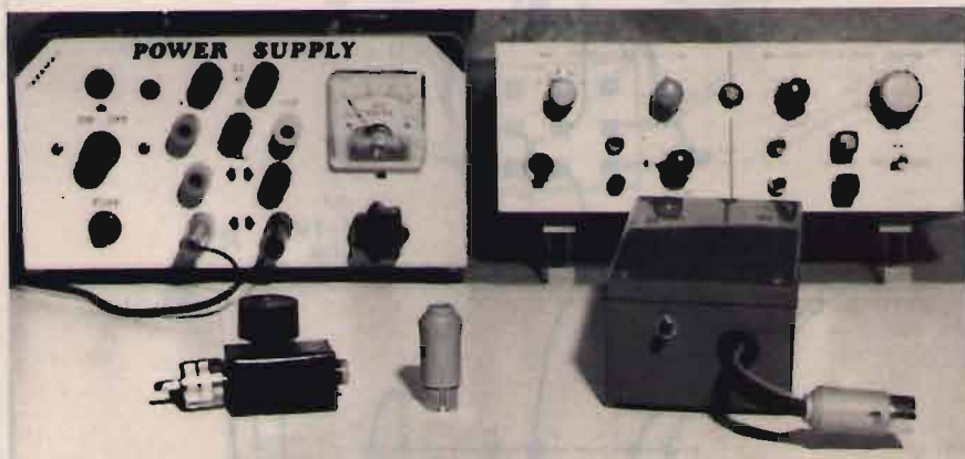
Da sinistra: l'attenuatore d'antenna della figura 6, il maschio DIN "di scorta", retro del BFO.
